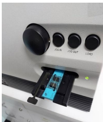
ภาพ Leja slide บนแท่นควบคุมอุณหภูมิของ CASA
