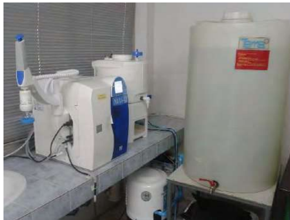
ภาพ เครื่องกรองน้ำใช้กรองน้ำให้เป็นน้ำกลั่น โดยกรองน้ำเบื้องต้น แล้วเข้า RO จากนั้นเข้า ชุดกรองน้ำบริสุทธิ์ Ultra pure
