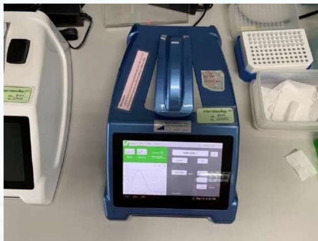
รูปที่ 3 - 12 เครื่องวัดปริมาณความเข้มข้นสารปริมาณน้อยโดยแรงดึงดูด (Nanodrop spectrophotometer: Nanodrop ND-1000, USA)
